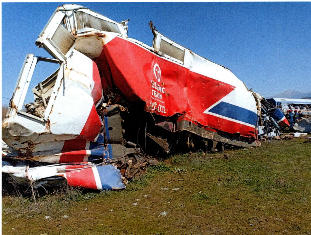
Πλαϊνή λήψη, εμφανής εκτεταμένη στρέβλωση κατά μήκος του άξονα κίνησης.
