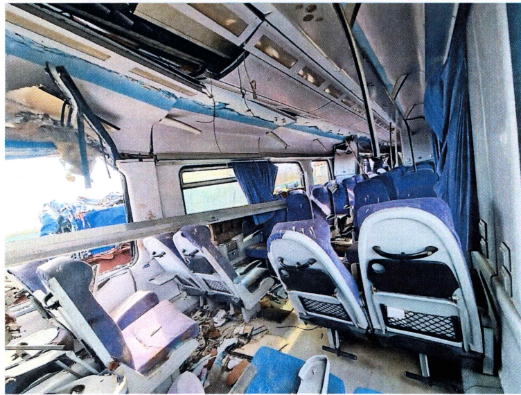
Εσωτερικό επιβατάμαξας νο.3. Ο εξοπλισμός / υλικά δεν έχουν επηρεαστεί από επίδραση πυρός.
