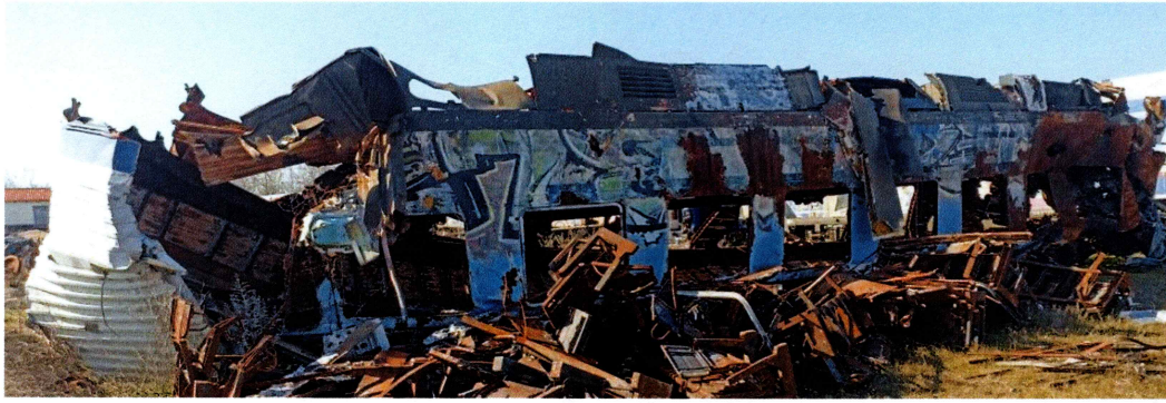
Πλευρικές λήψεις της επιβατάμαξας Νο 2. Το άνω τμήμα (οροφή) έχει αποτεθεί προς το έδαφος.
