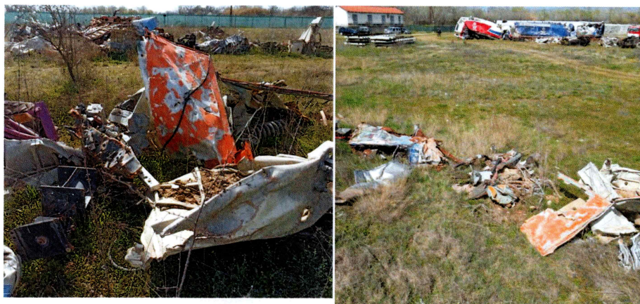
Τμήματα των συρόμενων θυρών της σκευοφόρου της Α' θέσης (προτοκαλί χρωματισμός, βλ. φωτογραφίες εσωτερικής διαρρύθμισης Α' θέσης στο μέρος Γ της παρούσης)
