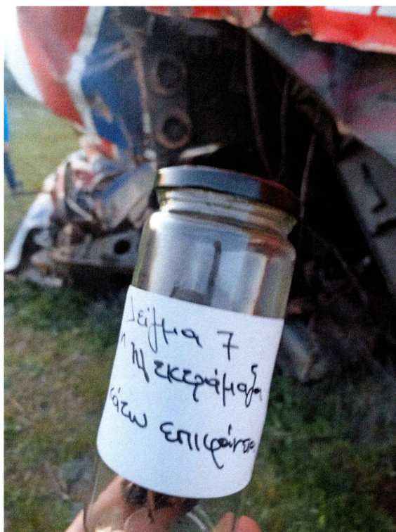
Ενεργηθείσα δειγματοληψία από προσωπικό του ΓΧΚ (επικαθίσεις επί μεταλλικών επιφανειών)
