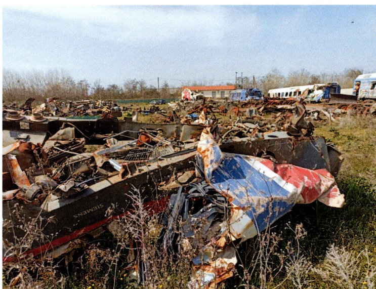
Δύο τμήματα του κυλικείου. Εμφανείς οι επιπτώσεις καύσης με διάρκεια και σταθερή ενταση.
