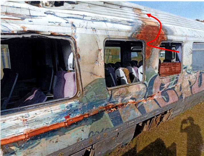
Γενική άποψη της επιβατάμαξας Νο 3 (δεύτερο βαγόνι Β' θέσης). Η απεικονιζόμενη πλευρά φέρει και το περιγραφέν διαμήκες πλήγμα. Επίσης εμφανείς οι στρεβλώσεις στα δύο άκρα αλλά και η φθορά από φωτιά πλησίον του ανοίγματος παραθύρου στο άνω δεξιό μέρος του καρέ.
