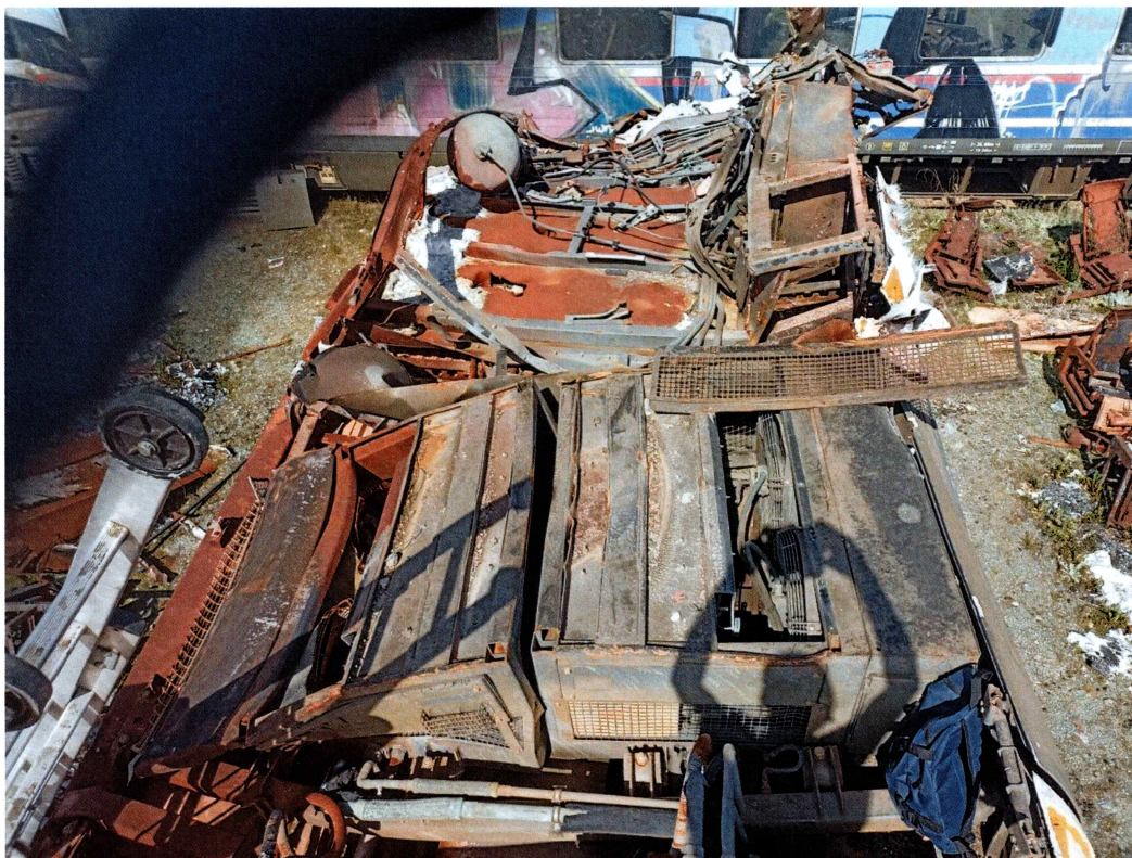
Κάτω πλευρά επιβατάμαξας Νο 2. Εμφανής ο χώρος των κλιματιστικών μονάδων (αναρτημένες κάτω από το βαγόνι) και αυτές με αλλοιώσεις από συνθήκες καύσης.
