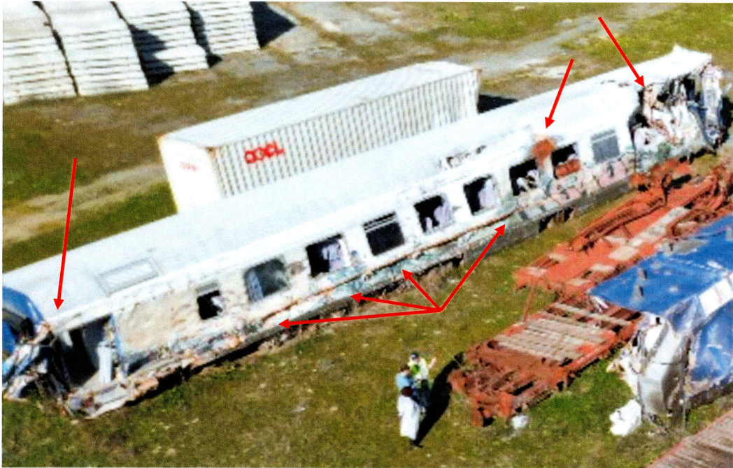
Γενική άποψη της επιβατάμαξας Νο 3 (δεύτερο βαγόνι Β' θέσης). Η απεικονιζόμενη πλευρά φέρει και το περιγραφέν διαμήκες πλήγμα. Επίσης εμφανείς οι στρεβλώσεις στα δύο άκρα αλλά και η φθορά από φωτιά πλησίον του ανοίγματος παραθύρου στο άνω δεξιό μέρος του καρέ.
