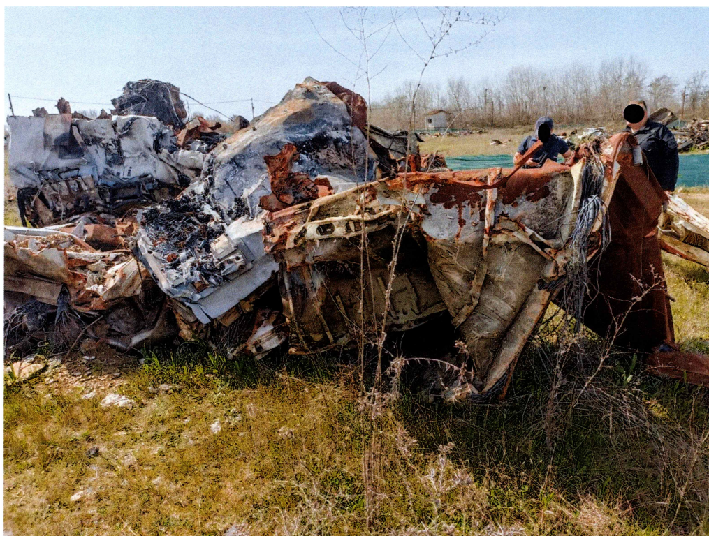
Συντρίμια επιβατάμαξας. Και εδώ εμφανείς οι αποτυπώσεις της φωτιάς επι των μεταλλικών επιφανειών.
