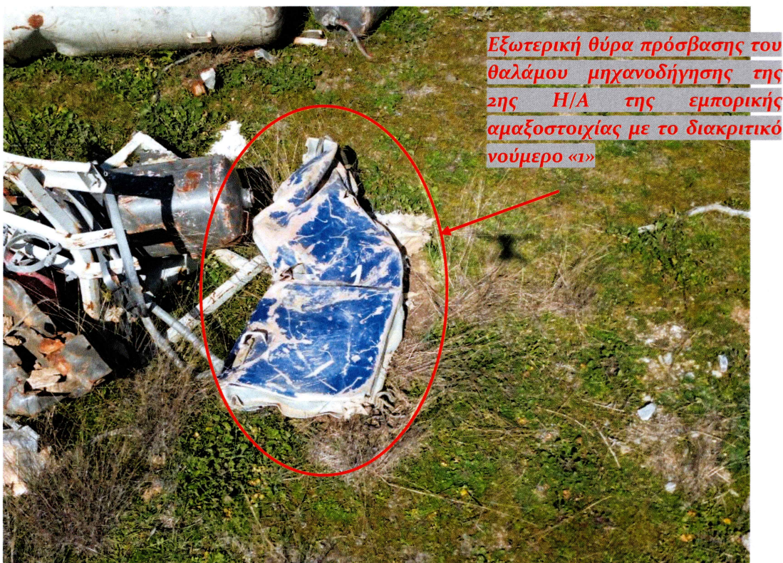
Απομακρυσμένη και εστιασμένη φωτογραφία που απεικονίζει την εξωτερική θύρα πρόσβασης του θαλάμου μηχανοδότησης της 2 ης Η/Α της εμπορικής αμαξοστοιχίας με το διακριτικό νούμερο «1».
