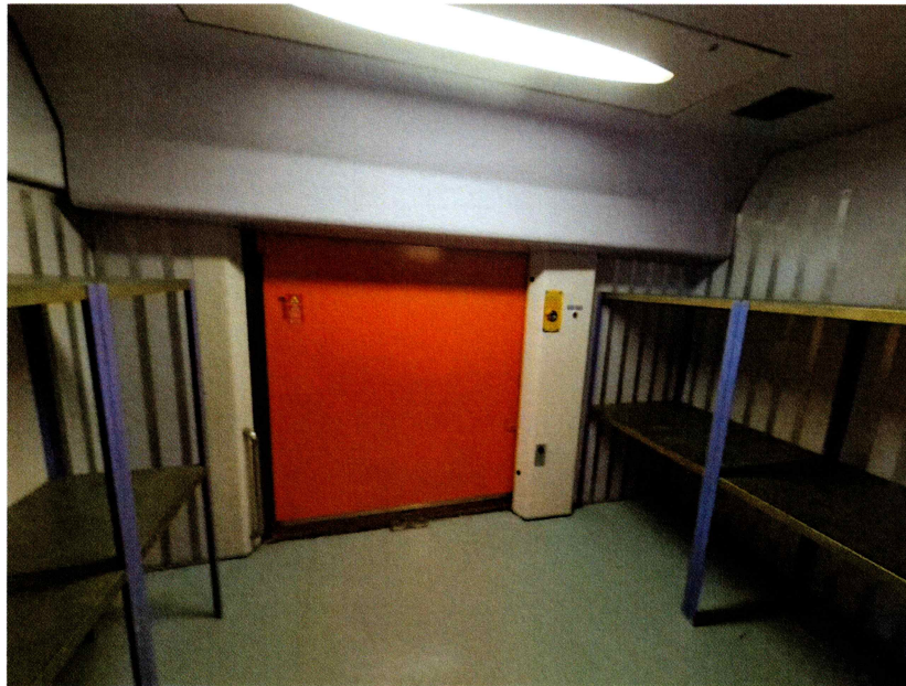
Χώρος σκευοφόρου επιβατάμαξας Α' θέσης. Το πορτοκαλί τμήμα είναι θύρα φορτοεκφόρτωσης
