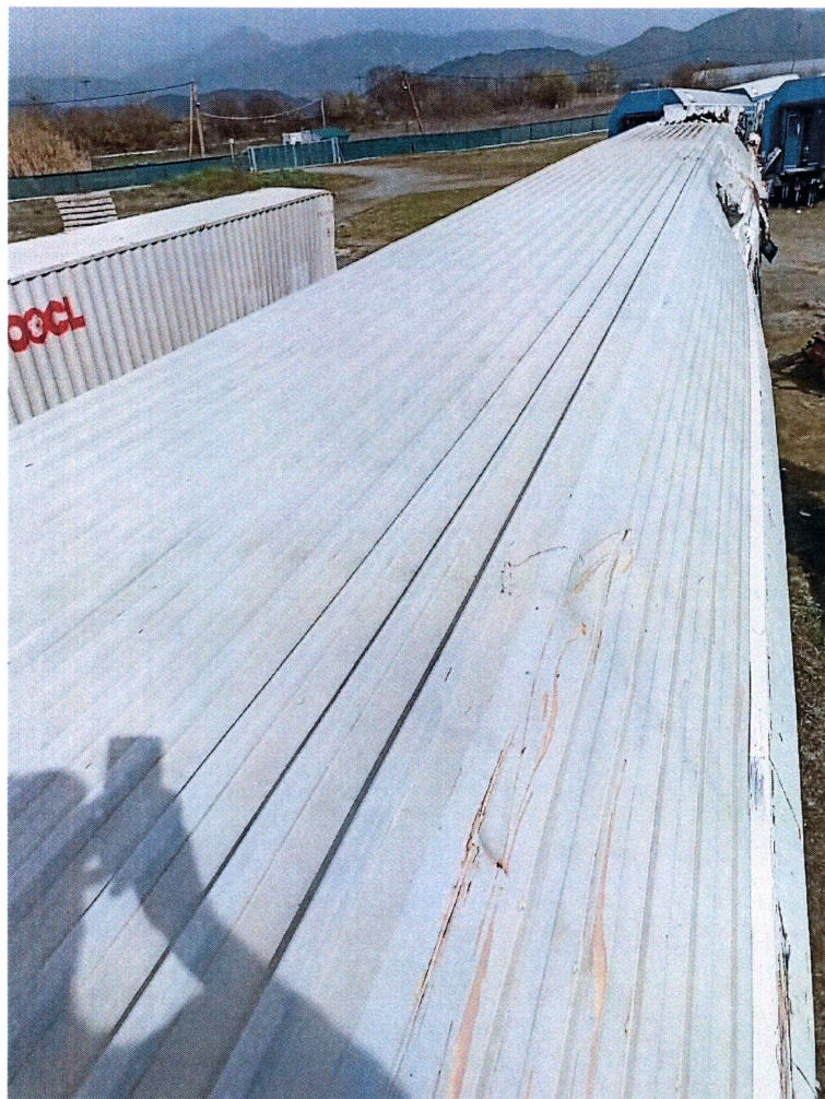
Άποψη της οροφής του βαγονιού. Καθαρή από πλευράς θερμικών αλλοιώσεων.
