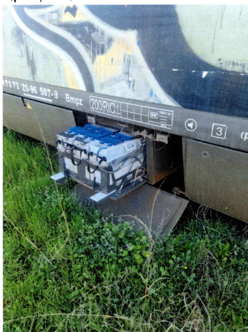
Συστοιχία ηλ. συσσωρευτών Ni-Cd και η θέση της σε μια επιβατάμαξα
