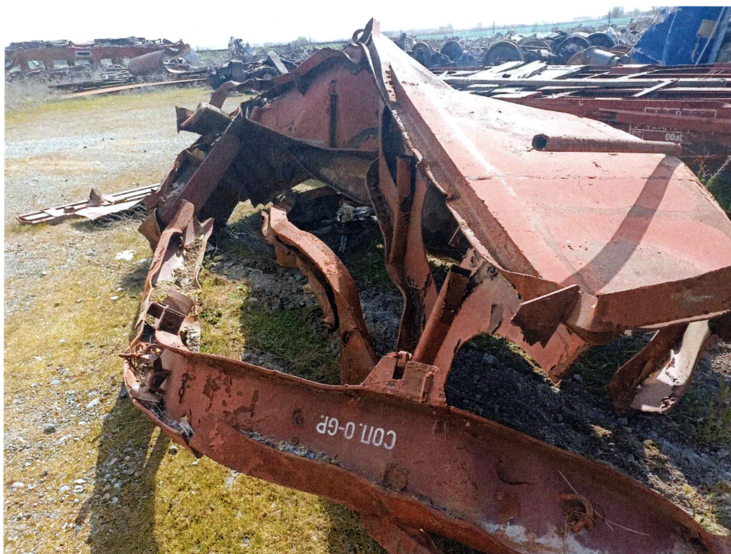
Λήψη από έτερη οπτική γωνία. Εμφανείς οι εκτενέστατες παραμορφώσεις συνεπεία της σύγκρουσης.
