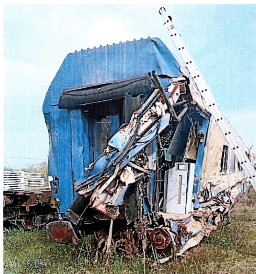
Άποψη της οροφής του βαγονιού. Καθαρή από πλευράς θερμικών αλλοιώσεων.
