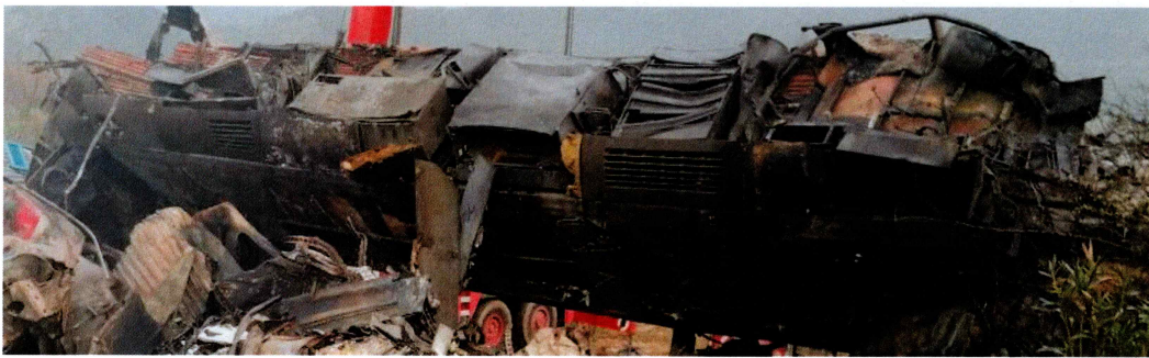
Η επιβατάμαξα Νο 2. Επί τόπου του δυστυχήματος, προ της μετακίνησής της. Εμφανής η ανεστραμμένη θέση της, με ορατό το κάτω τμήμα της και απόντα τα δύο φορεία των τροχών κύλισης.
