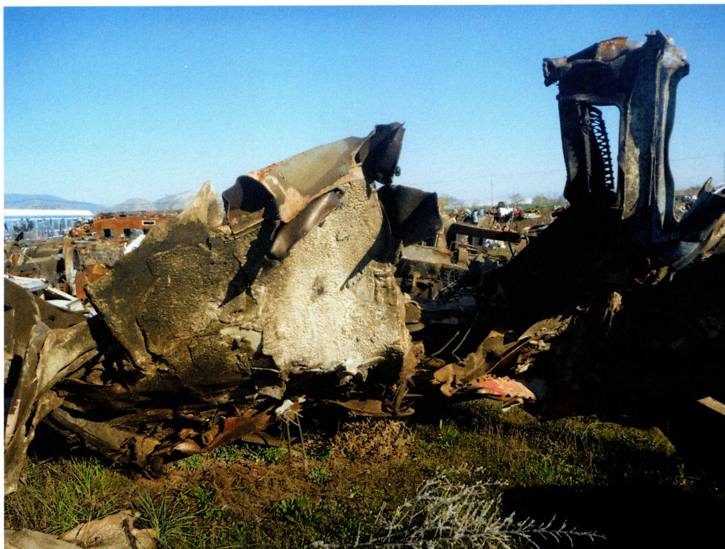
Τμήμα 1 ης εμπορευματικής Η/Α με ίχνη που συμβαδίζουν με έκθεση σε μέτριας εντάσεως καύση.
