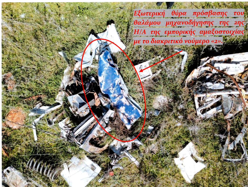
Απομακρυσμένη και εστιασμένη φωτογραφία που απεικονίζει την εξωτερική θύρα πρόσβασης του θαλάμου μηχανοδότησης της 2 ης Η/Α της εμπορικής αμαξοστοιχίας με το διακριτικό νούμερο «2».
