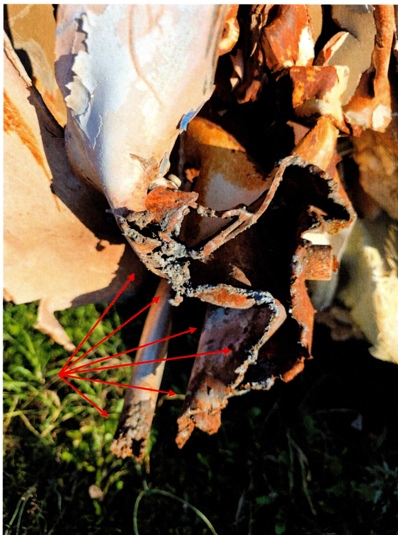
Λεπτομέρεια της παραπάνω φωτογραφίας (εντός ερυθρού κύκλου). Εμφανή σημάδια σημειακής τήξης μετάλλου.
