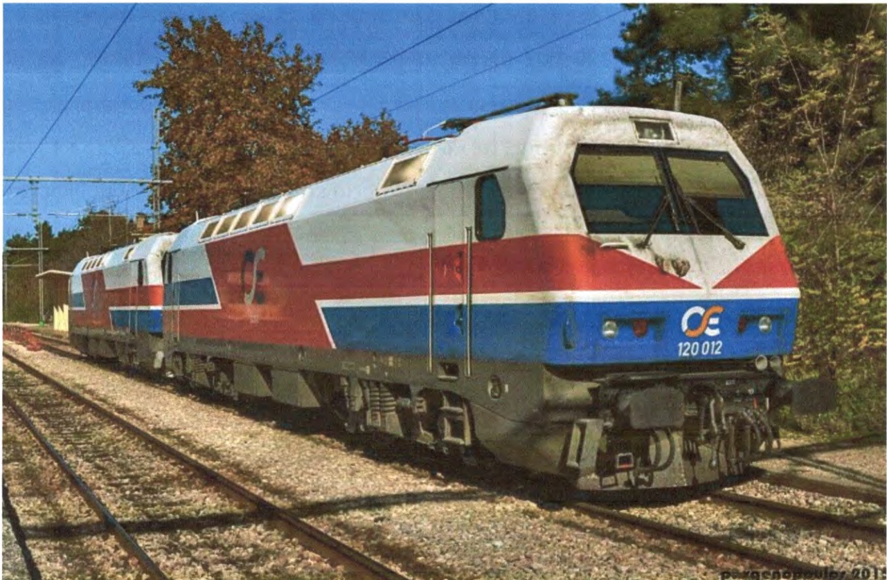
Εικόνα 4: Ηλεκτράμαξα EuroSprinter Siemens Krauss -Maffei 120 012, Τύπος: ES64U4 (φωτ αρχείου)
