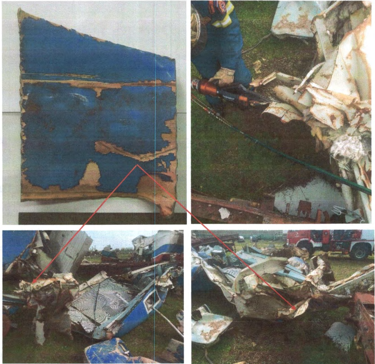
Εικόνα 8: Δείγμα "Κ1β" (Κόκπιτ 1β) από την δεξιά πλευρά της οροφής του Θαλάμου Μηχανοδότησης
