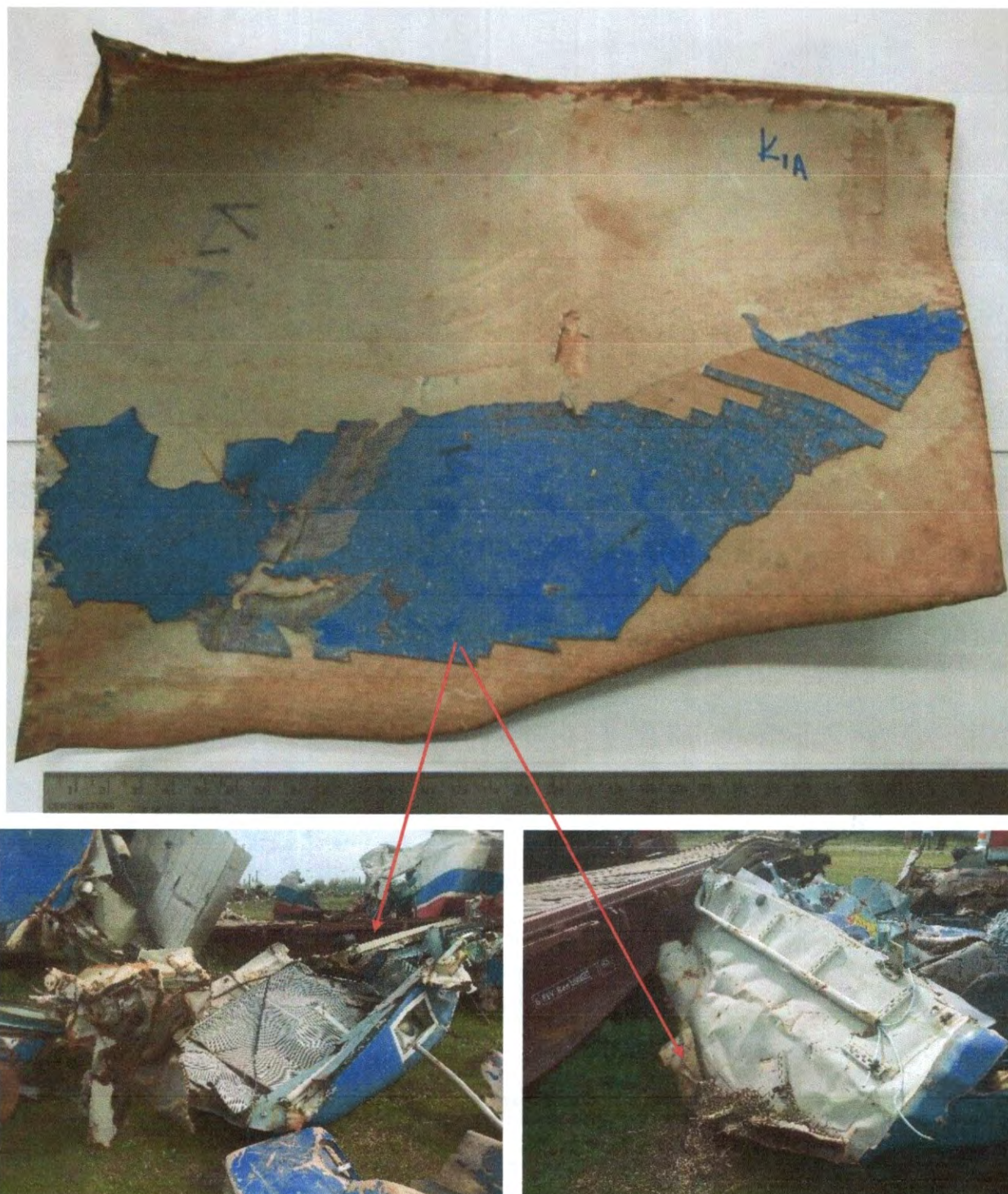
Εικόνα 7: Δείγμα "Κ1α" (Κόκπιτ 1α) από την αριστερή πλευρά της οροφής Θαλάμου Μηχανοδήγησης
