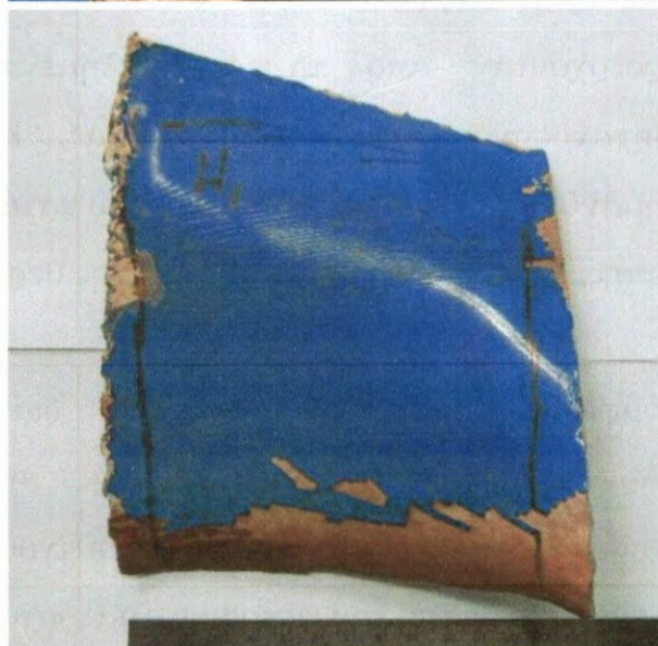
Εικόνα 5: Δείγμα "H1" (Ηλεκτράμαξα 1), από το πίσω και αριστερά τμήμα της αποκόλλησης
