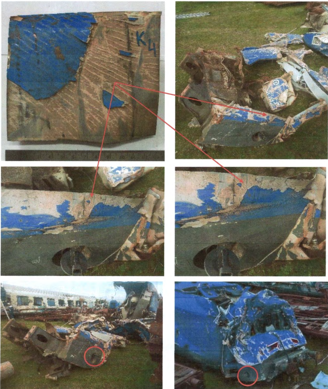
Εικόνα 11: Δείγμα “K4” (Κόκπιτ 4) από το πάνω τμήμα της βάσης-προφυλακτήρα του Θαλάμου Μηχανοδήγησης (συγκριτικά με τον έτερο Θάλαμο Μηχανοδήγησης της εν λόγω Ηλεκτρομηχανής)
