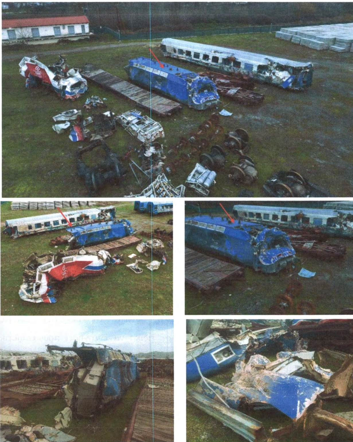
Εικόνα 3: Διακρίνονται η 2 η Ηλεκτράμαξα, με αριθμό 120 012, της υπ' αριθμ. 63503 εμπορικής αμαξοστοιχίας, όπως επίσης και τμήματα-θραύσματα του αποκολλημένου Θαλάμου Μηχανοδήγησης, φυλασσόμενα ως πειστήρια στη θέση "Κουλούρι" Λάρισας
