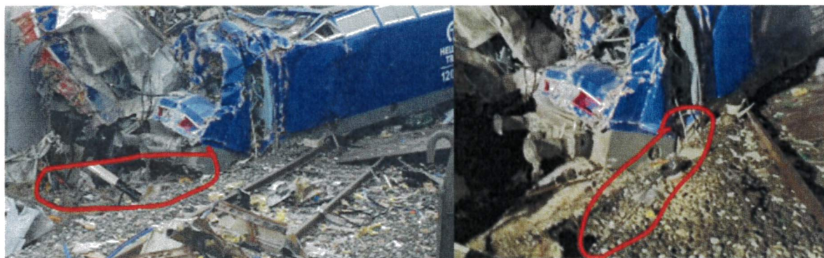
Εικόνα 12: Η αλυσσοειδής γραμμή επαφής κάτω από την εμπορική ηλεκτράμαξα (20230301-105223.jpg & 20230301-034238.jpg)
