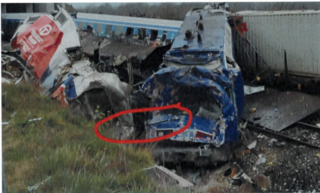
Εικόνα 13: Ηλεκτράμαξες εμπορικής αμαξοστοιχίας – Εξακολουθούν να είναι συνδεδεμένες ηλεκτρικά (βύσματα UIC) (20230301-071311.jpg)
