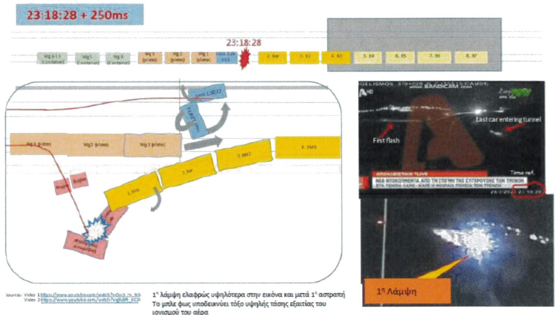
Σχήμα 5: Πρώτο ηλεκτρικό τόξο στην εναέρια γραμμή του ηλεκτροφόρου αγωγού
