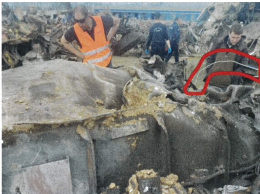
Εικόνα 15: Ο μετασχηματιστής της Η/Α 120-023 με συγκεντρωμένη την αλυσοειδή γραμμή επαφής. Απόσπασμα από αρχείο 230307_123525.jpg
