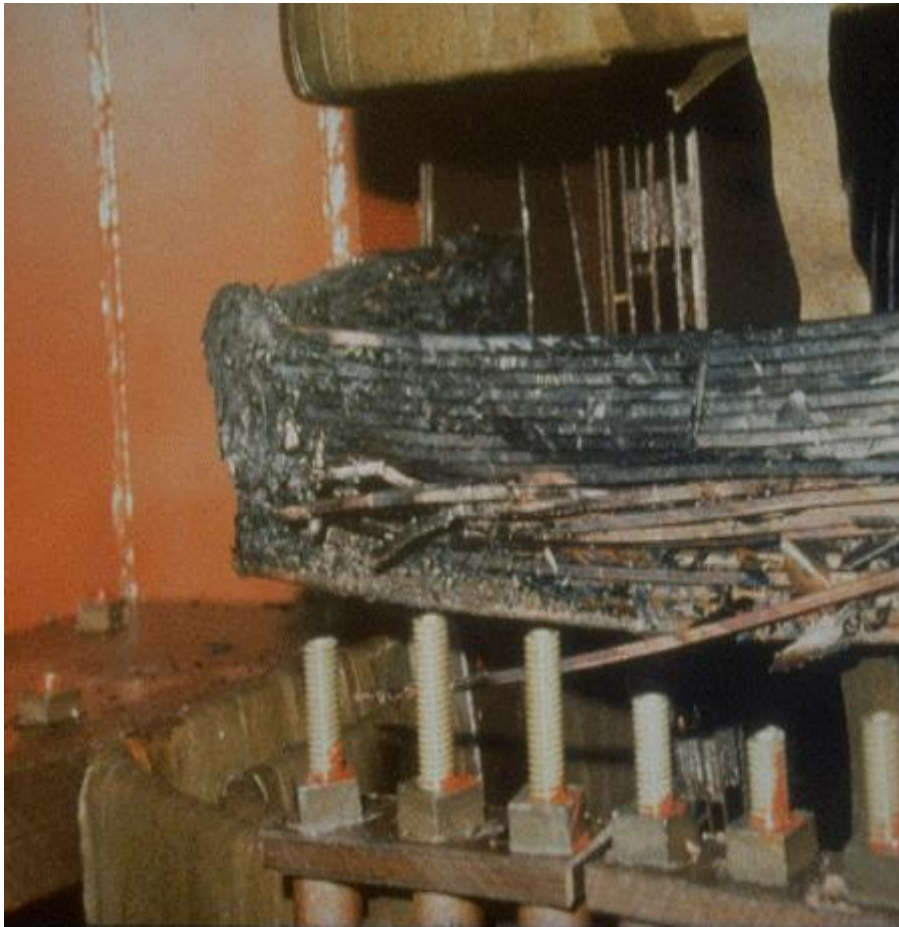
Εικόνα 1. Η εικόνα ενός μετασχηματιστή της Public Service Electric and Gas Company μετά την έλευση μίας ηλιακής έκλαμψης τον Μάρτιου του 1989 [1].
