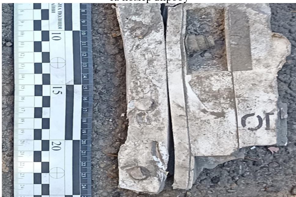
Рисунок 4 – Фрагмент кріплення опорного шпангоута з написом “Опора”
