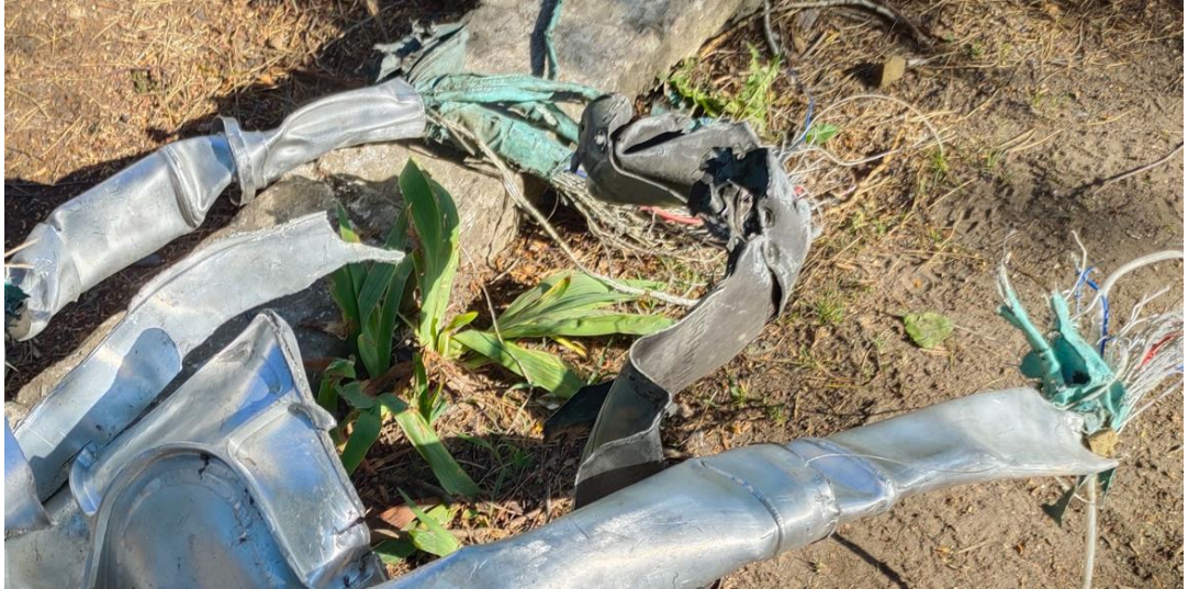
Рисунок 36 – Характерна ознака Х-101 – ізоляція проводки тканиною
