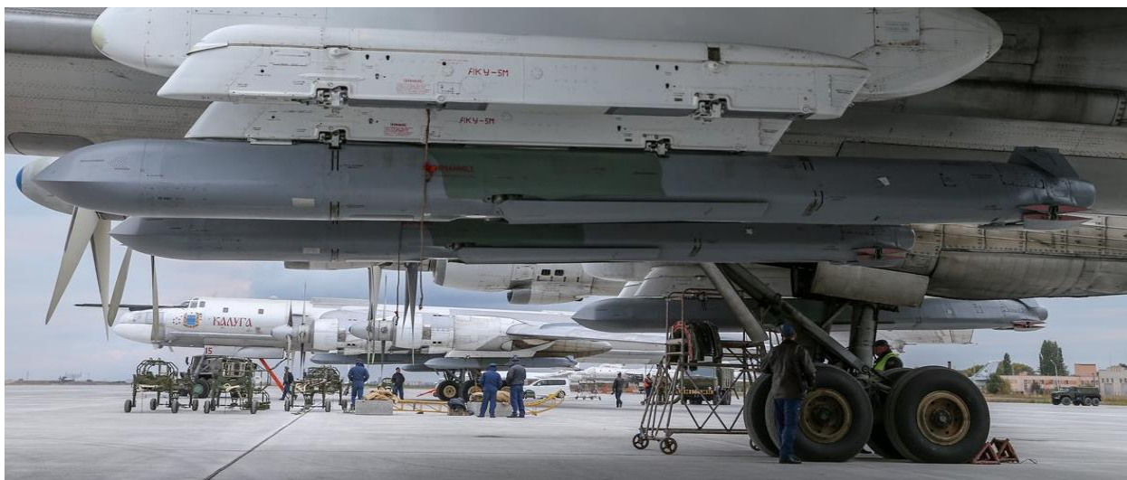
Рисунок 14 – Х-101 на підвісці бомбардувальника Ту-95МС
