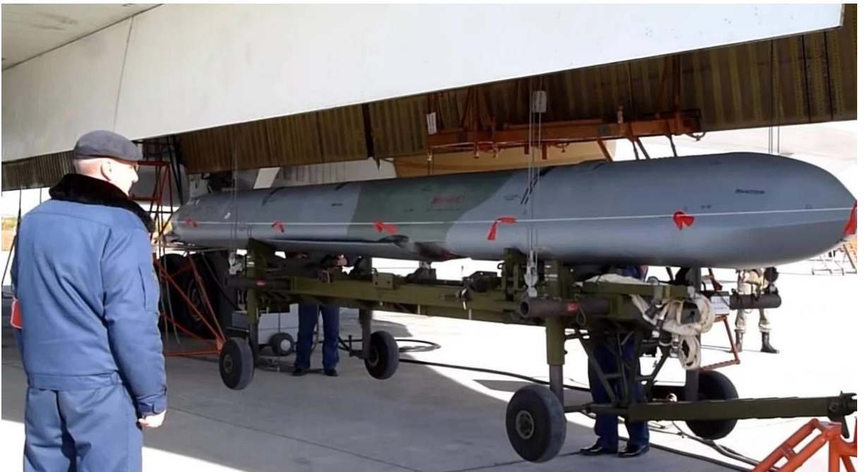
Рисунок 17 – Підвішування Х-101 на пускову установку Ту-160
