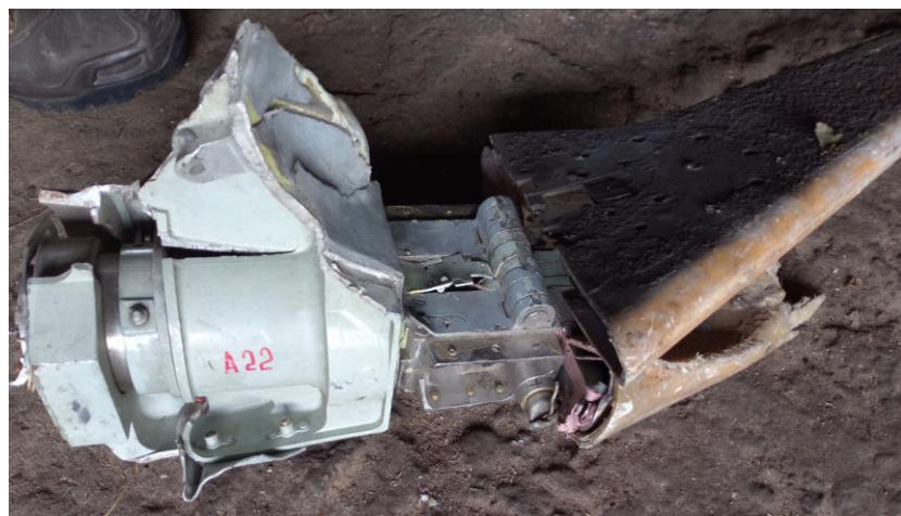
Рисунок 34 – Замок кріплення, поворотний механізм з маркуванням “A22” і фрагмент лівої горизонтальної площини керма
