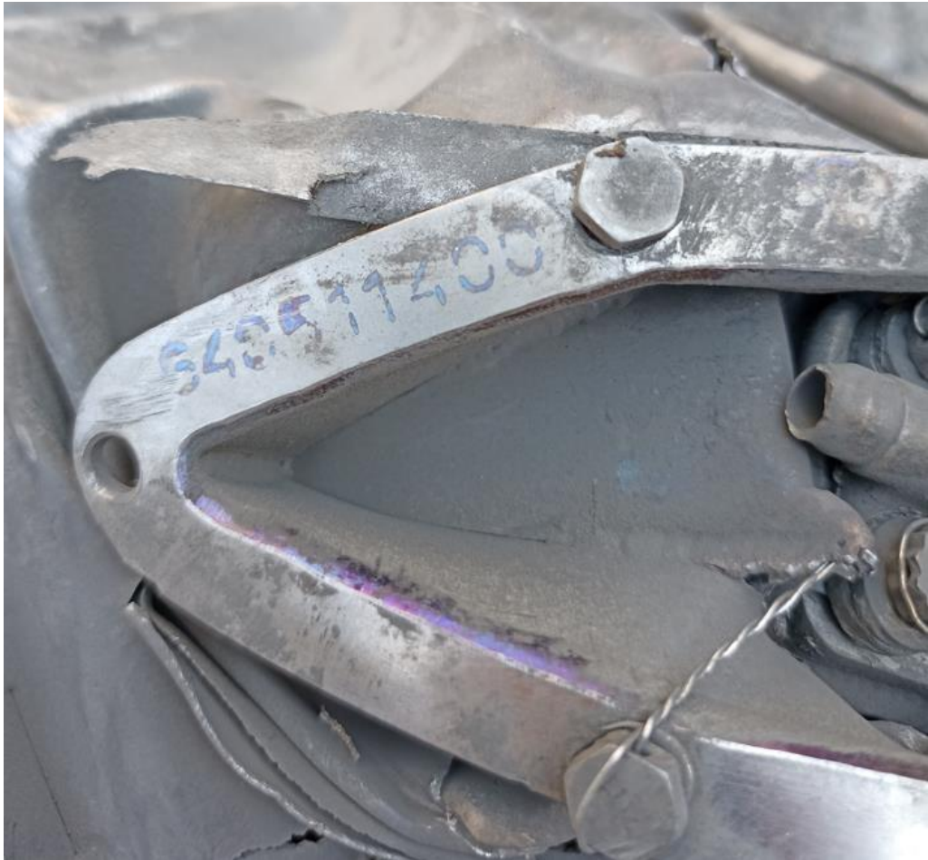
Рисунок 9 –Приклад маркування на двигуні “Изделие 64М”
