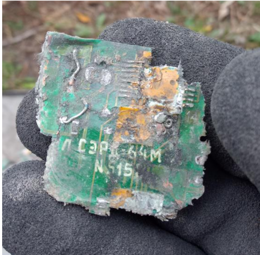
Рисунок 13 – Фрагмент плати з маркуванням “СЭРД-64М” (назвою системи керування двигуном “Изделие 64М”)
