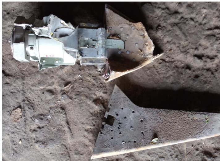
Рисунок 35 – Замок кріплення, поворотний механізм з маркуванням “A22” і фрагмент лівої горизонтальної площини керма
