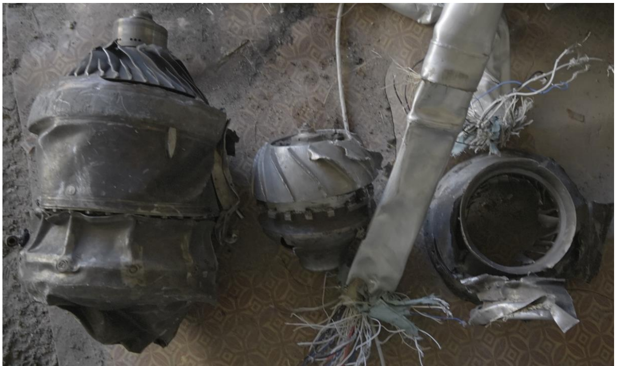
Рисунок 30 – Маршовый двигатель ракеты – ТРДД-50А(М) / “Изделие 36М”
