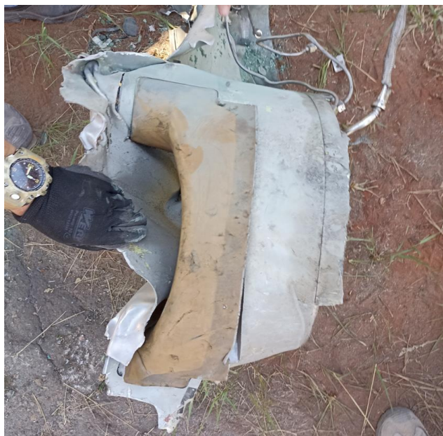
Рисунок 54 – Матеріал ізолюючої обшивки крайки повітрозабірника
