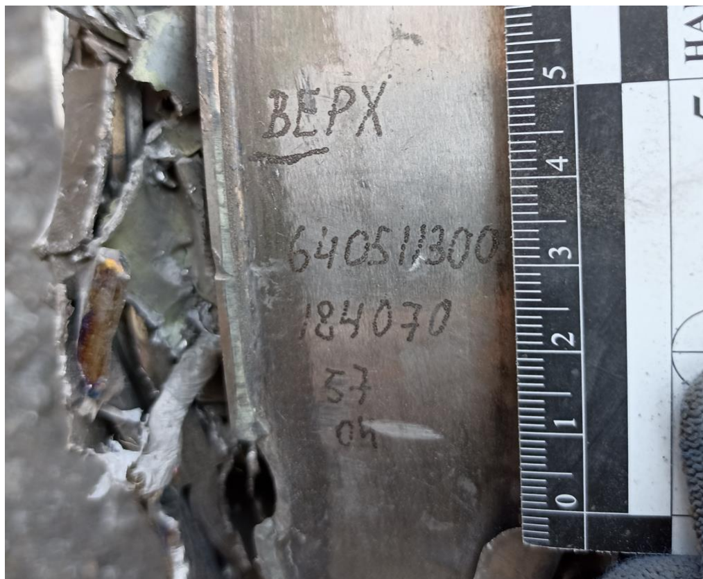
Рисунок 10 –Приклад маркування на двигуні “Изделие 64М”
