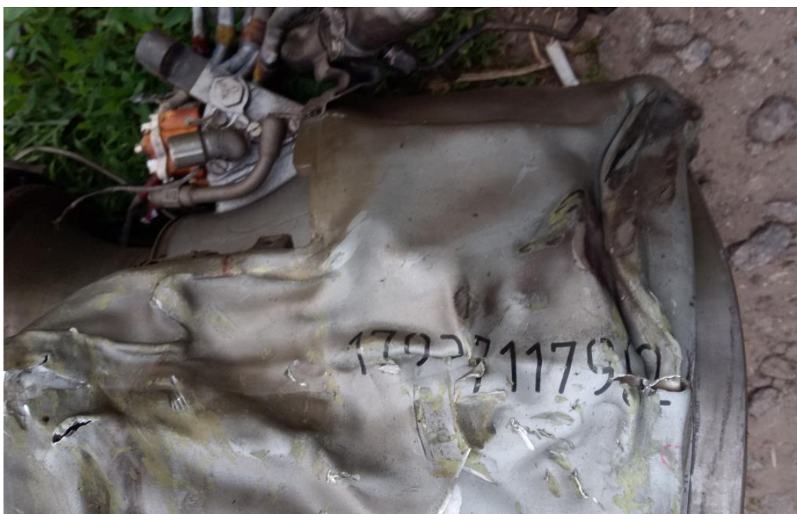
Рисунок 62 – Серійний номер ТРДД-50Б – на сірому фоні, у Х-101 на жовтому Прилади крилатої ракети 3-М14, їх функціональне призначення та короткий опис наведені в таблиці 10.
