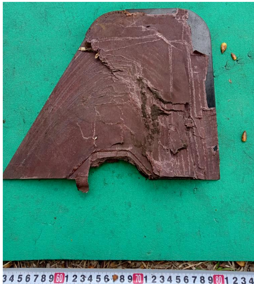
Рисунок 47– Пошкоджене композитне оперення керма на “хвостовику” ЗМ-14
