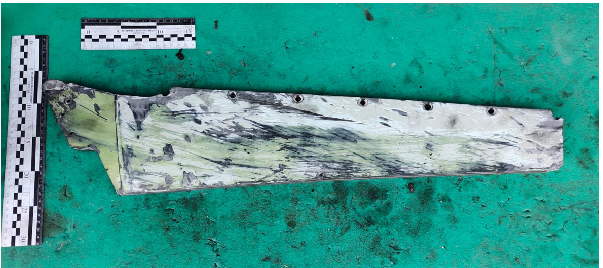
Рисунок 23 – Опорний лонжерон крилатої ракети “Калібр”
