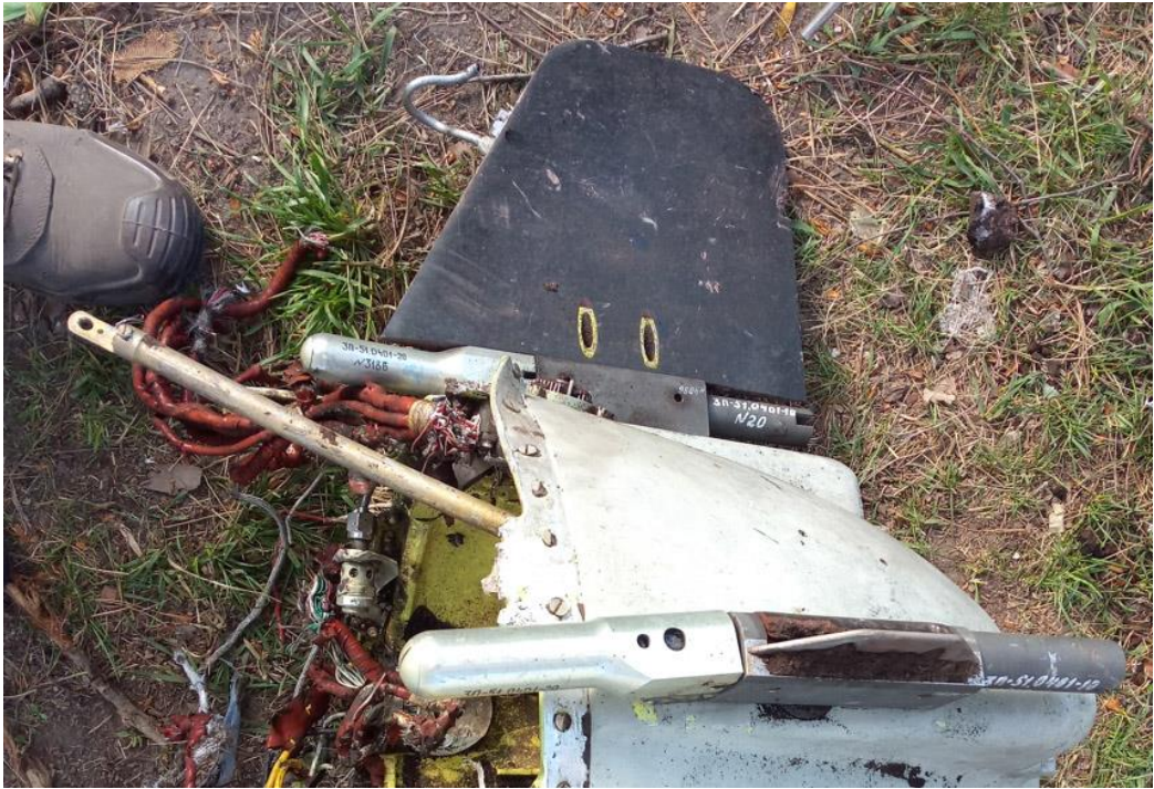
Рисунок 46 – Композитне оперення керма на “хвостовику” ЗМ-14
