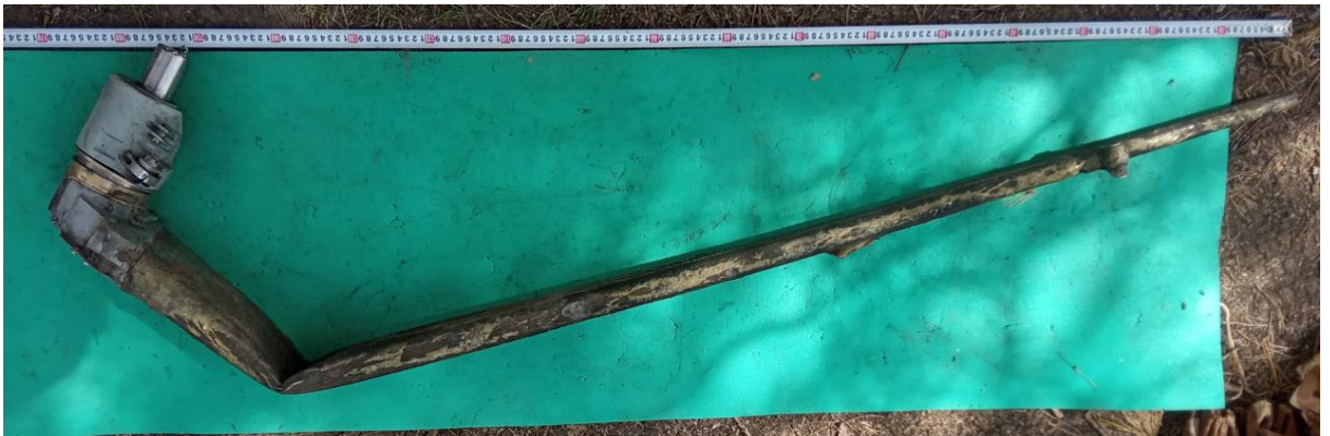
Рисунок 24 – Опорний лонжерон крилатої ракети X-101
