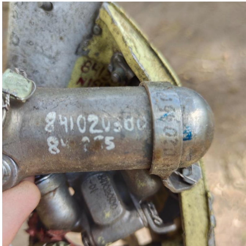
Рисунок 32 – Приклад маркування з цифрами “84” на початку номера
