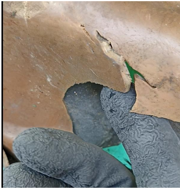
Рисунок 53 – Матеріал ізолюючої обшивки крайки повітрозабірника
