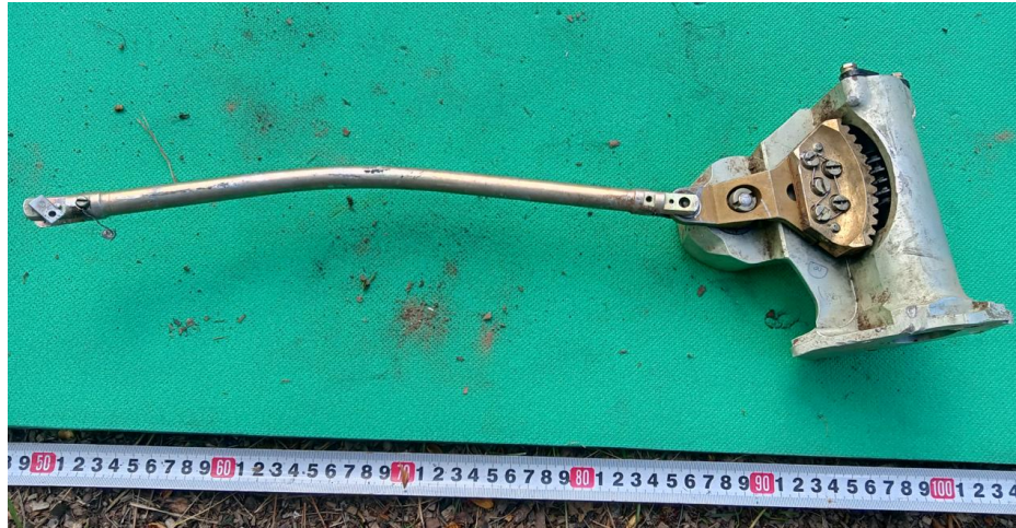
Рисунок 50 – Тяга і механічна передача керма ЗМ-14
