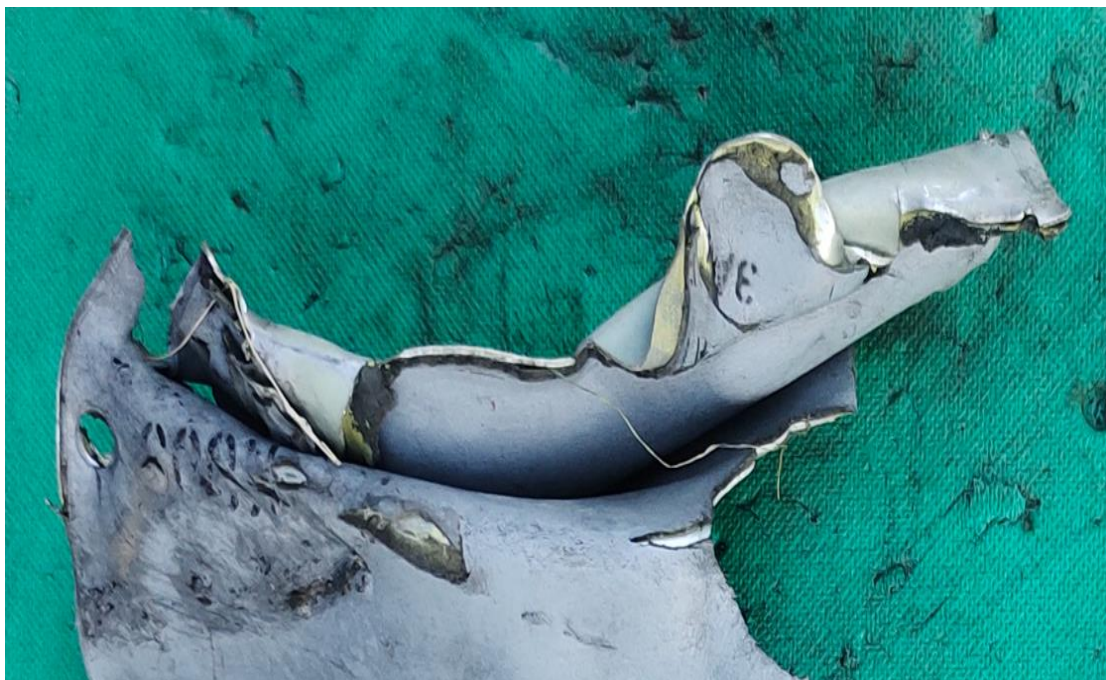
Рисунок 19 –Ізоляційне покриття обшивки, зовні схоже на гуму – характерна ознака X-101”
