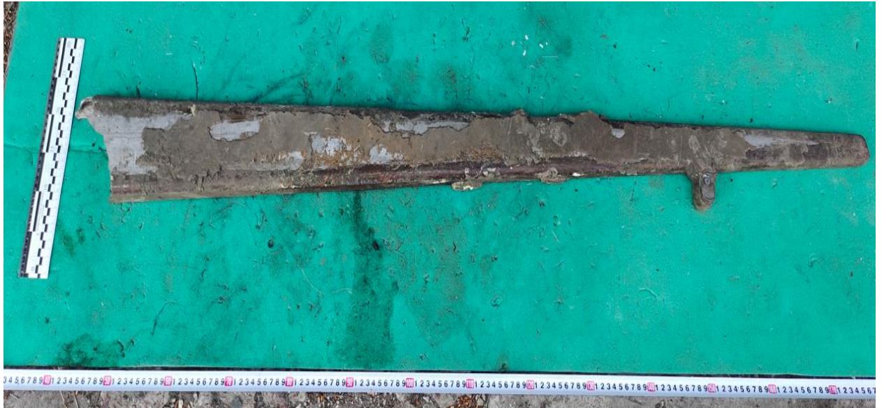
Рисунок 25 – Опорний лонжерон крилатої ракети X-101
