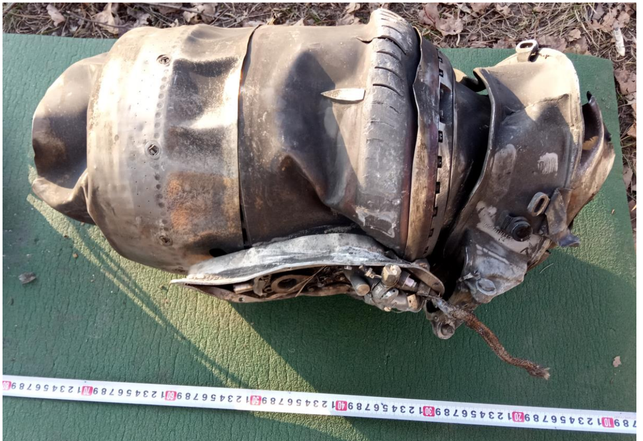
Рисунок 29 – Маршовый двигатель ракеты – ТРДД-50А(М) / “Изделие 36М”
