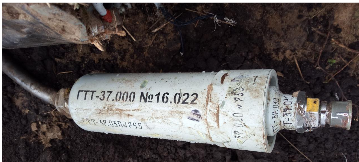
Рисунок 61– Виносний блок з маркуванням “ГТТ” – відмінна риса двигуна ТРДД-50Б, що відрізняє його від ТРДД-50А (Х-101) та “Изделия 64М” (Х-35У)
