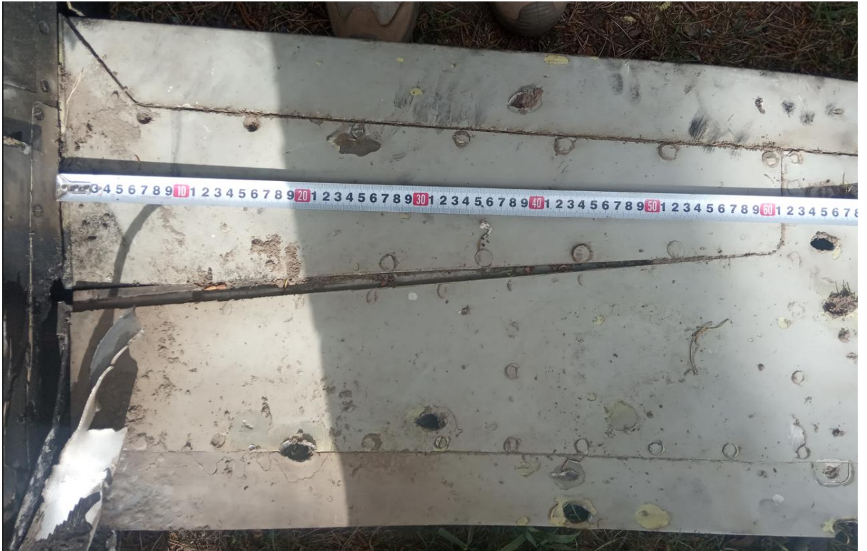
Рисунок 57 – Опорний лонжерон крила “Калібра” та “Іскандера” має довжину 61 см, на відміну від 170 см для Х-101
