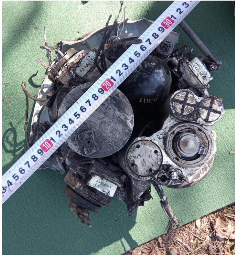
Рисунок 27 – Блок виконавчих механізмів керма “К-005”
