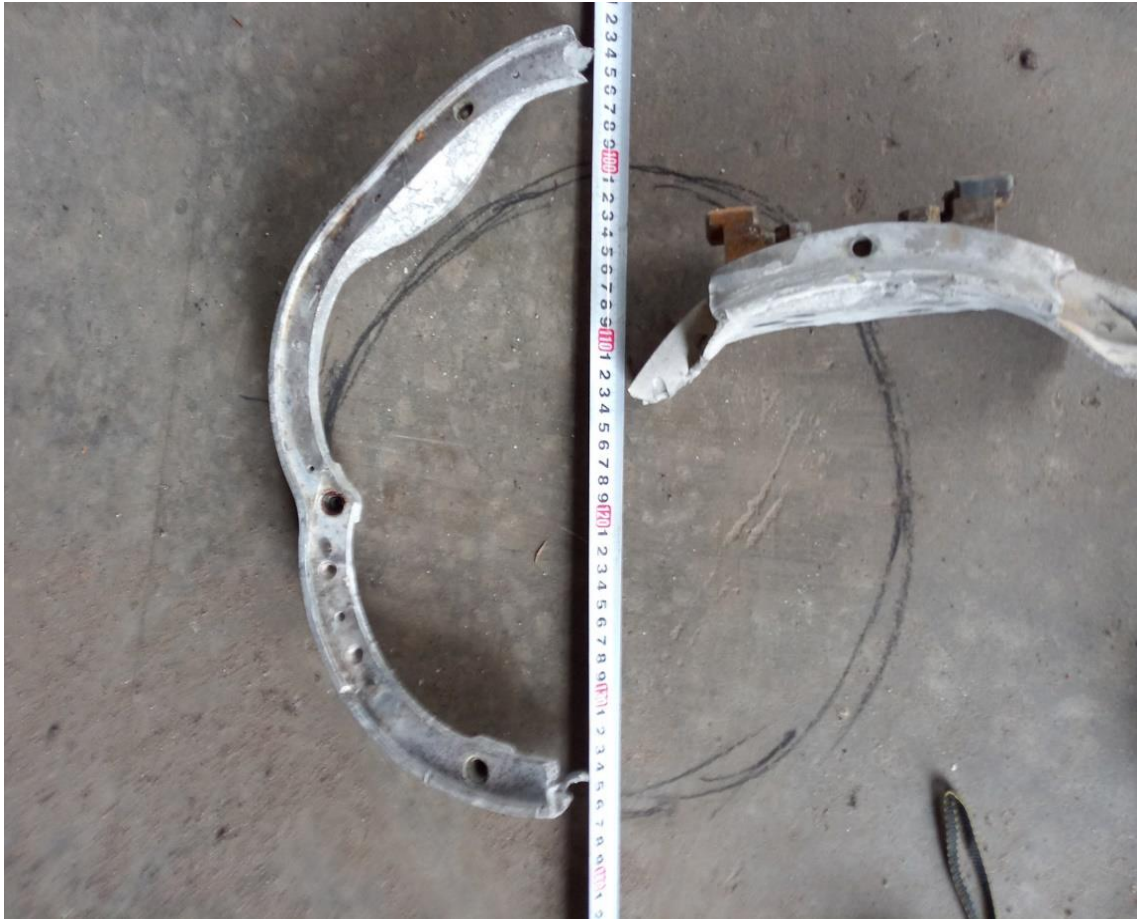
Рисунок 7 – Опорні шпангоути вісімкоподібної форми
