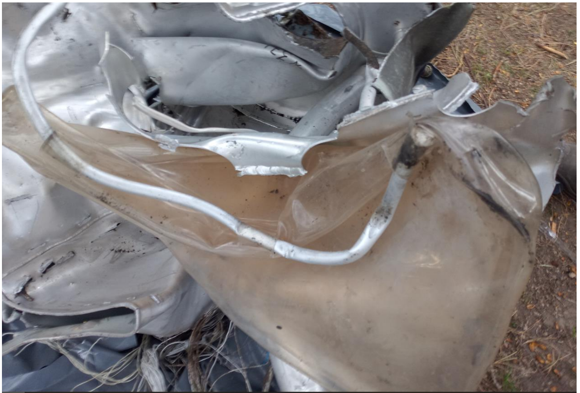
Рисунок 56 – прозорі силіконові ємності - елемент паливної системи
