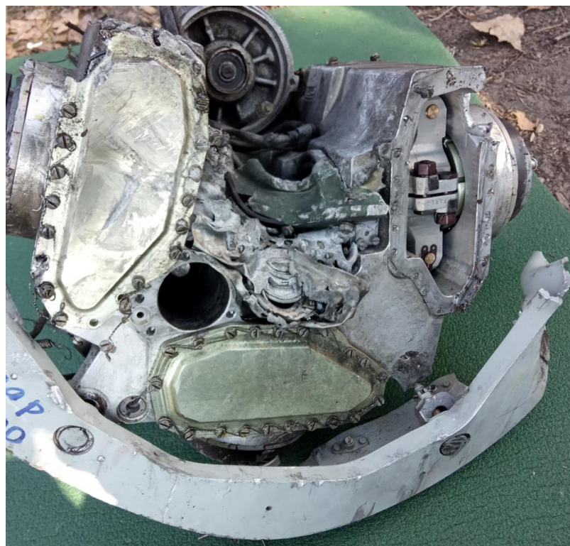
Рисунок 28 – Блок виконавчих механізмів керма “К-005”
