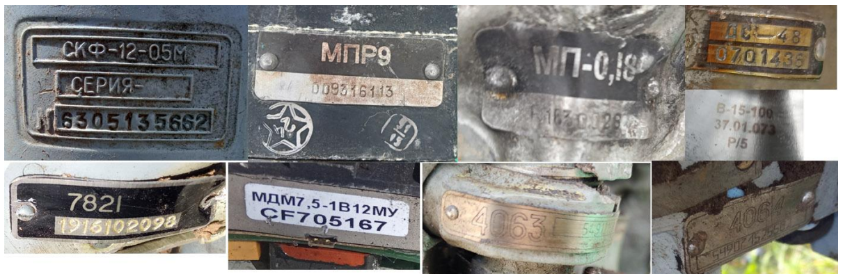
Рисунок 52 – Типові маркування окремих вузлів хвостової частини ракети
